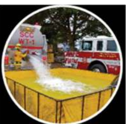
Extinción de Incendios - Llenado del tanque de agua
