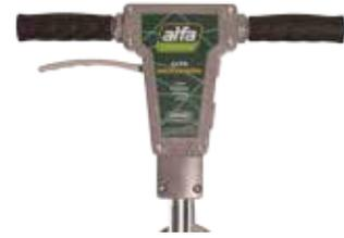
Dispone de cuadro eléctrico fabricado en material termoestable ignífugo, con Clase de Aislamiento H (180°C), y palanca de activación on/off.
